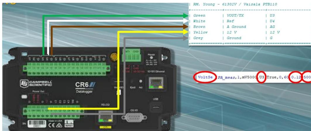
Gambar 20. Penyambungan sensor tekanan dengan data logger CR 6
