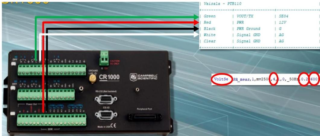
Gambar 21. Penyambungan sensor tekanan dengan data logger CR 1000
